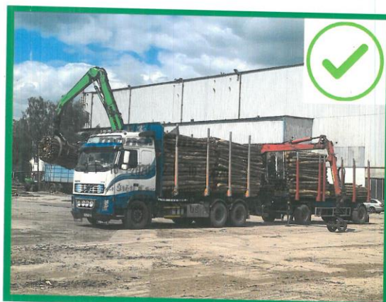
Správné odložení hydraulické ruky na skladě
