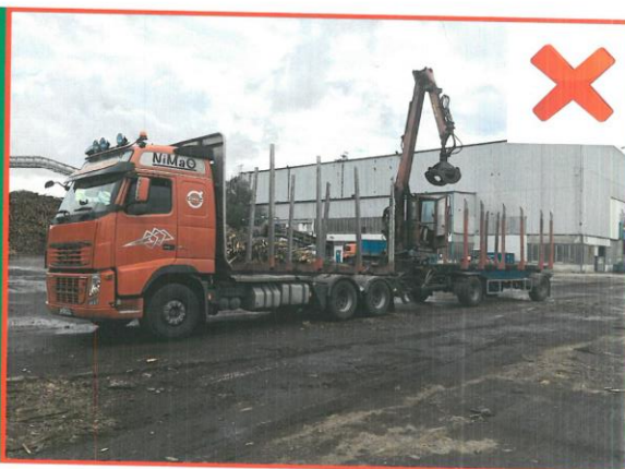
Zakázané odložení hydraulické ruky na skladě
